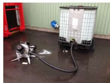
小型放水砲及び泡消火薬剤
