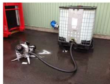
小型放水砲及び泡消火薬剤
