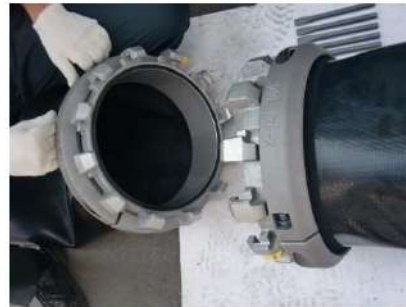
可搬型ホース(300A)接続
