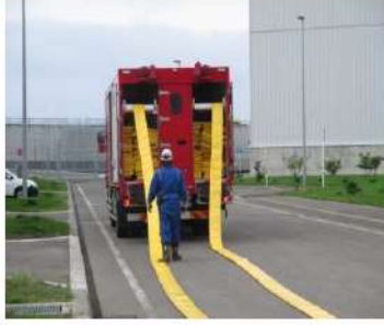
ホース延長・回収車（送水車用）による 可搬型ホース敷設 （屋外）
