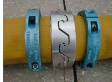
可搬型ホース (150A) 接続後
