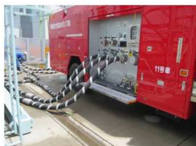
【図1 可搬型大型送水ポンプ車】
