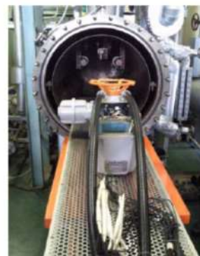
図2 蒸気曝露試験装置
