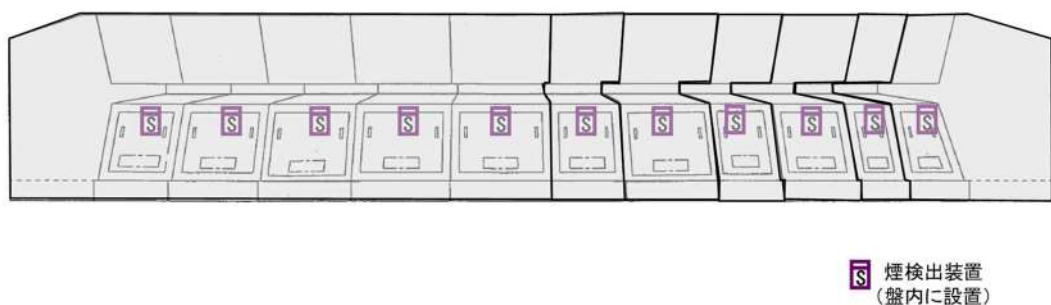
図 2. 4. 3 中央制御盤 煙検出装置配置
