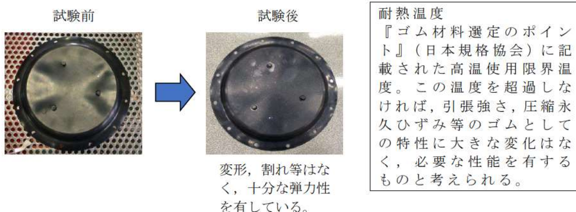
図2 試験前後のダイヤフラムの状態
