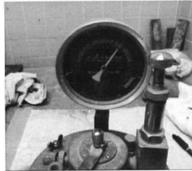
CCb 工法仕様上向き空気量測定
