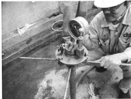
CCb 工法仕様上向き空気量測定
