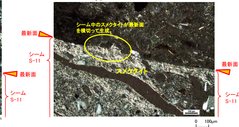
図4.2.16 スメクタイトがシームS-11の最新面を横切る形状の薄片観察結果
