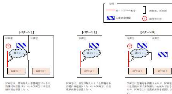
図2 区画配置温度検出器設置概念図
