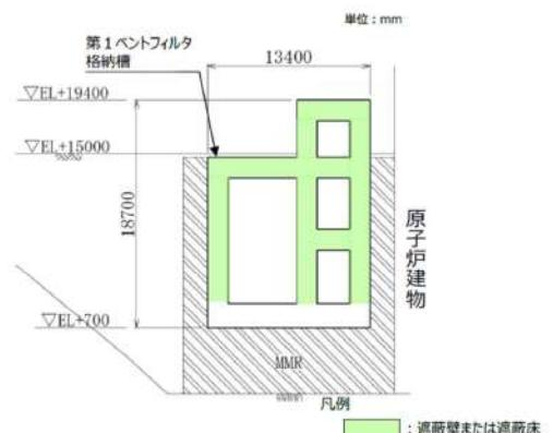
第6-2-5-4図 第1ベントフィルタ格納槽 断面図
