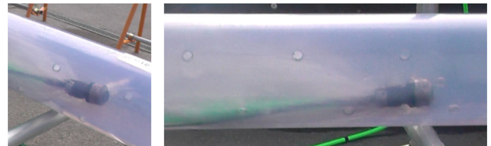
図8 管内清掃装置進行時の様子 (添付5-4(4)図)
