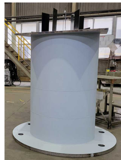
縮尺試験体の鋼構造部
