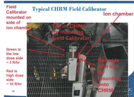
参考図 典型的な格納容器高レンジ放射線モニタ(CHRMs)の現場較正器、ML21327A271.
