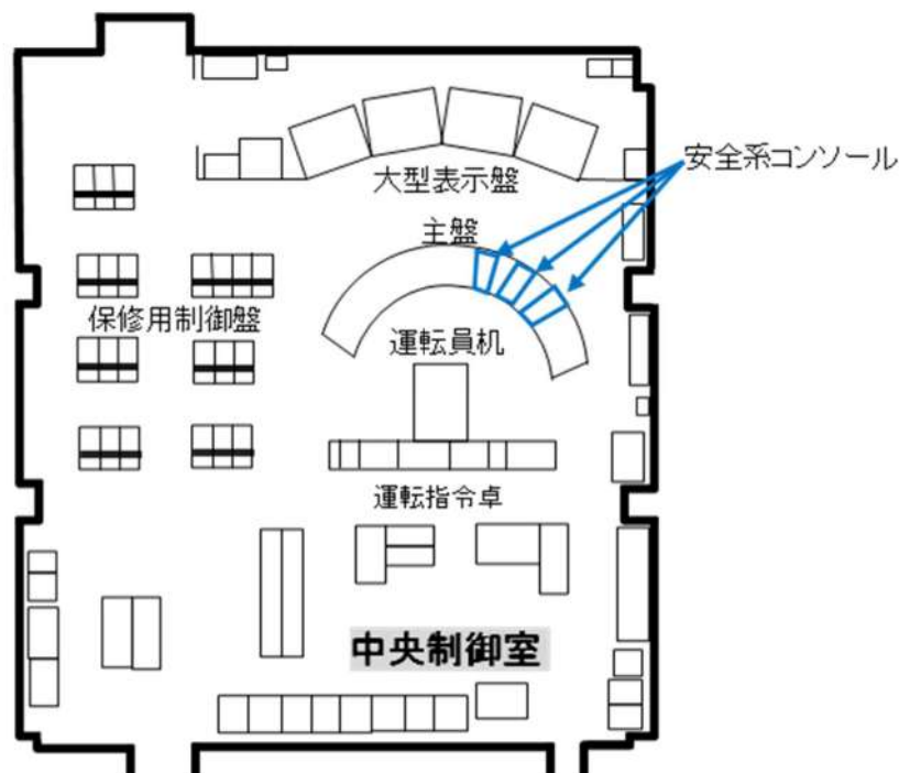
第1図 中央制御室配置図
