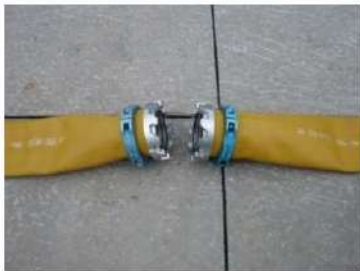
可搬型ホース（150A）接続前
