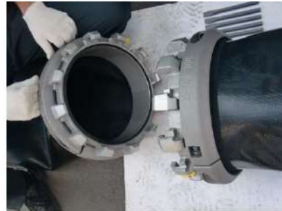
可搬型ホース(300A)接続
