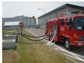
水源への吸管挿入 (屋外)
