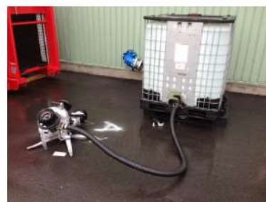
小型放水砲及び泡消火薬剤
