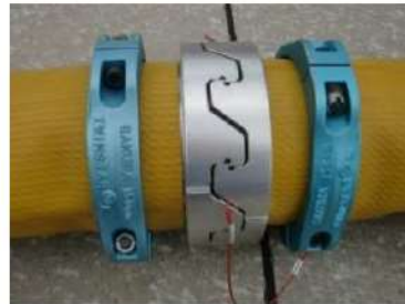
可搬型ホース(150A)接続後
