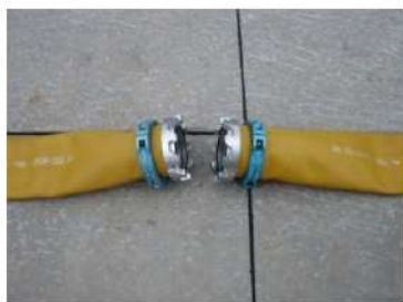
可搬型ホース（150A）接続前
