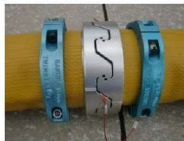
可搬型ホース(150A) 接続後
