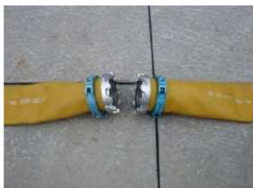
可搬型ホース(150A) 接続前
