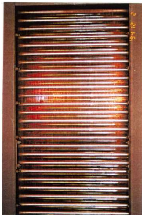
冷却水ヘッダー部 (冷却水温度計測用熱伝対取付状態)
