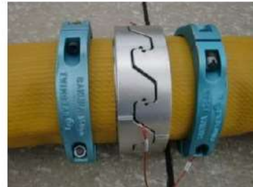
可搬型ホース (150A) 接続後
