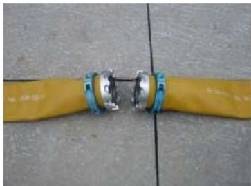
可搬型ホース (150A) 接続前
