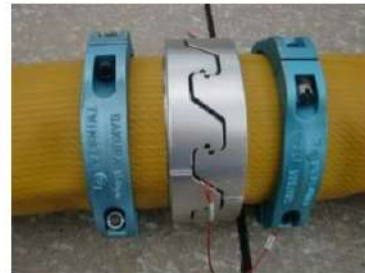
可搬型ホース（150A）接続後
