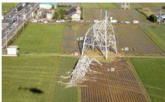
強風による送電鉄塔の倒壊事例① ※1
