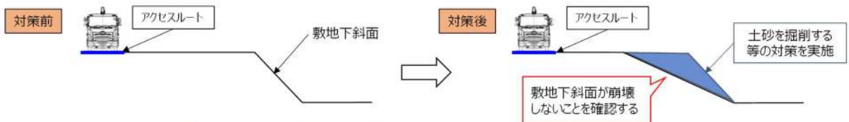
第 7.2-1 図 敷地下斜面に対する土砂掘削等の対策
