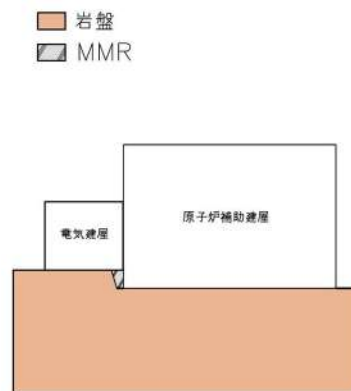
第3図 電気建屋の設置状況（断面②）
