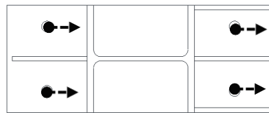
図 3-21 アンカーボルトに生じる荷重の例
