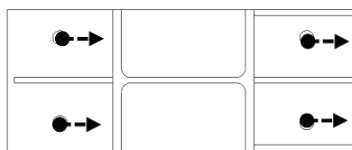
図 4.4-10 アンカーボルトに生じる荷重の例
