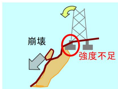
【急傾斜地の崩壊】
