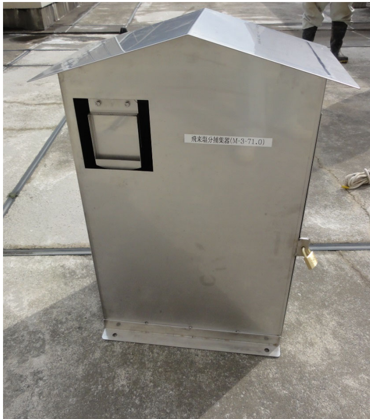
図 4. 1. 4 - 1 飛来塩分捕集器 (土研式塩分捕集器)
