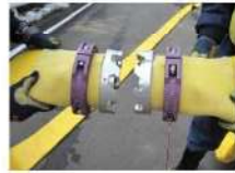
② 可搬型ホース接続（接続前）
