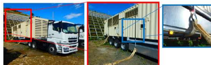
図4 固縛装置の取り付けイメージ
