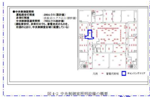
図4-2 中央制御室照明設備の概要
