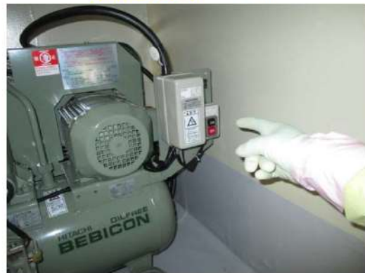
可搬型代替ガスソフリング圧縮装置起動 (周辺補機棟 T. P. 24. 8m)
