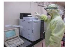
ガス分析計による水素濃度測定 (原子炉補助建屋 T. P. 6. 3m)
