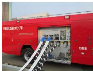
可搬型大型送水ポンプ車 周辺のホース敷設 （屋外 T. P. 10. 3m）
