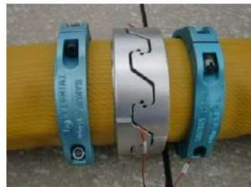
可搬型ホース(150A) 接続後
