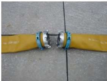
可搬型ホース(150A)接続前
