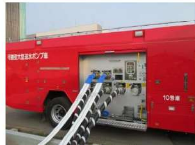
可搬型大型送水ポンプ車 周辺のホース敷設 （屋外 T. P. 10. 3m）
