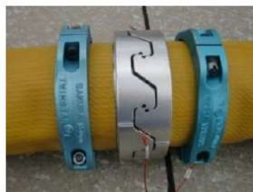
可搬型ホース（150A）接続後
