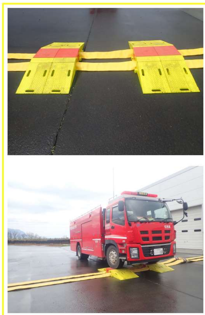
第1図 ホースブリッジの設置状況
