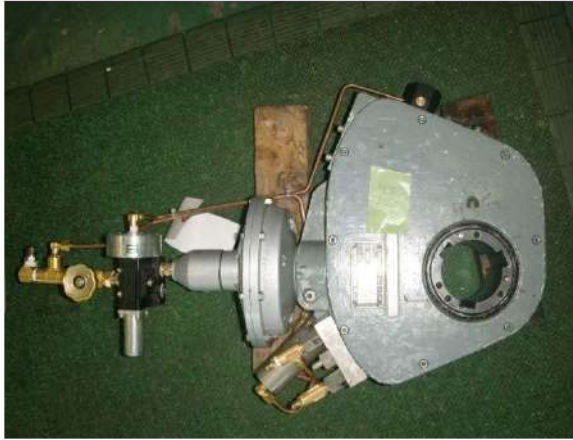
蒸気暴露試験後
