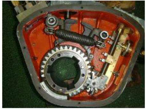
蒸気暴露試験後
