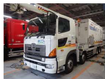
可搬型大容量 海水送水ポンプ車
