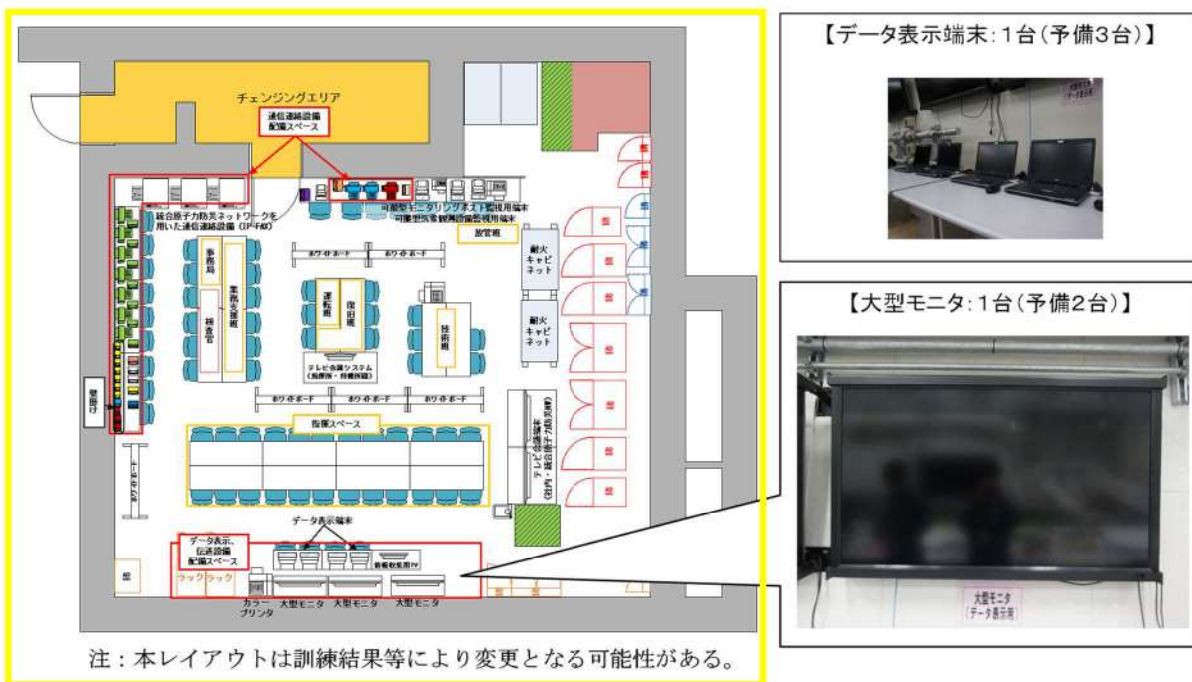
参考第 5-1 図 緊急時対策所における SPDS パラメータ表示の概要
