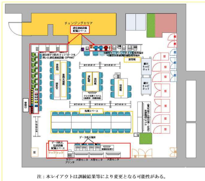
図 1.1-1 緊急時対策所指揮所 配置図
