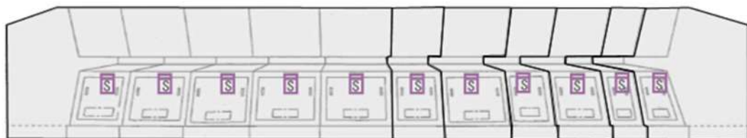
煙検出装置 (盤内に設置)
