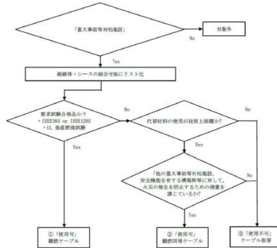
第1図：難燃性ケーブル確認方法
