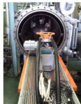
図2 蒸気曝露試験装置
