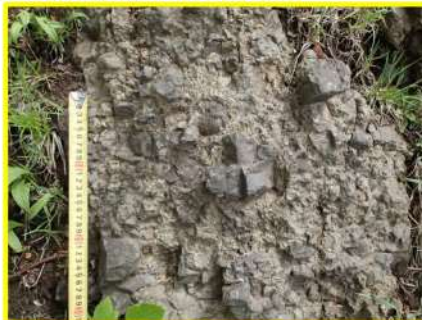
P6 防災科研調査において地滑り土塊北側端部とされる箇所付近の露岩状況 堅硬な岩盤(凝灰角礫岩)が認められる。
