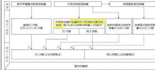
図1 被ばく経路（緊急時対策所指揮所及び緊急時対策所待機所）
