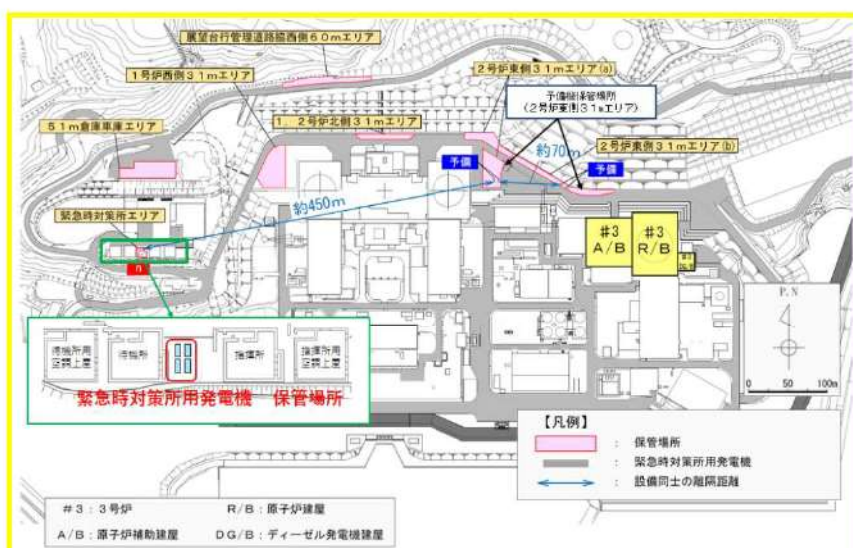
図4-10 緊急時対策所用発電機の保管場所
