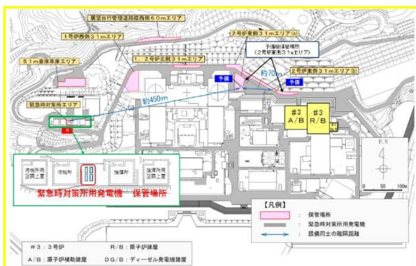
図4-10 緊急時対策所用発電機の保管場所
