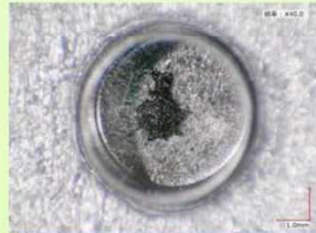
試験後 (1200°C窒素ガス環境下)
