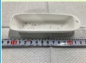
試験後 (1000°C水蒸気環境下)
