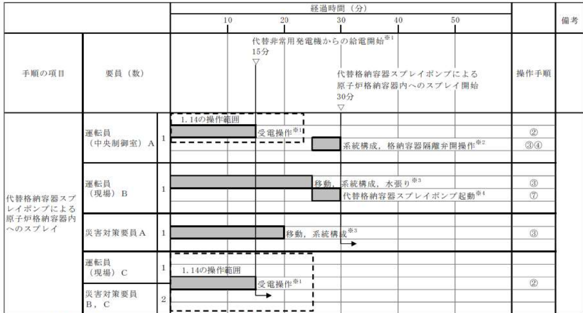
図 2.7-7 全交流動力電源喪失又は原子炉補機冷却機能喪失時の代替格納容器スプレイポンプによる原子炉格納容器内へのスプレイ タイムチャート ※2
