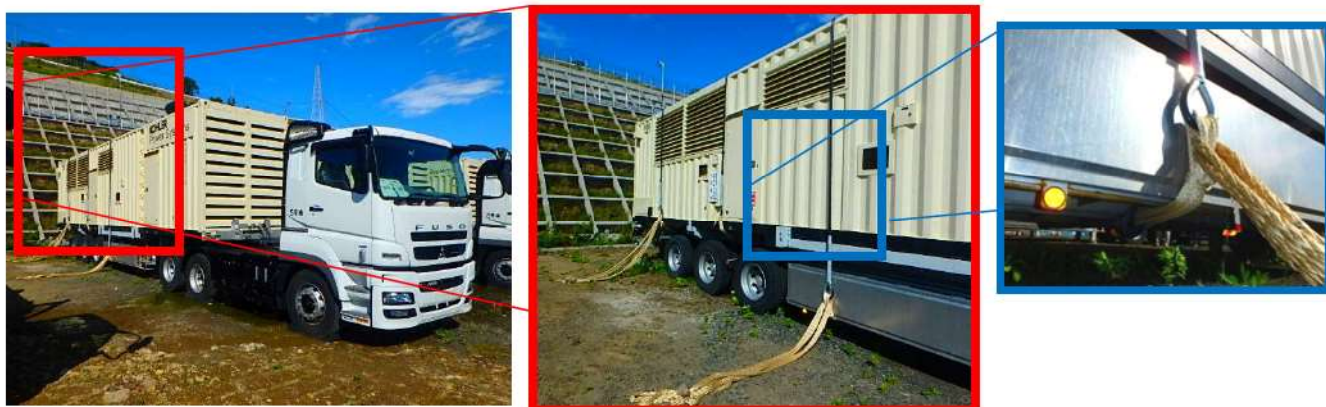
図4 固縛装置の取り付けイメージ
