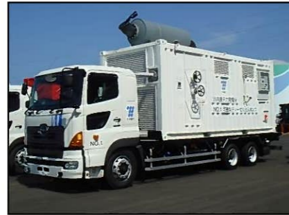
可搬型ディーゼル注入ポンプ
