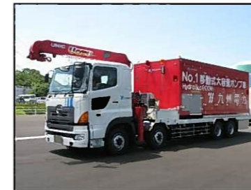
移動式大容量ポンプ車
