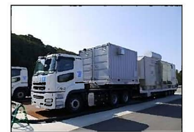
中容量発電機車
