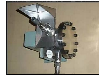
電気式水素燃焼装置
