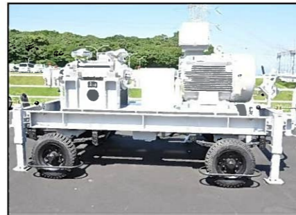
可搬型電動低圧注入ポンプ
