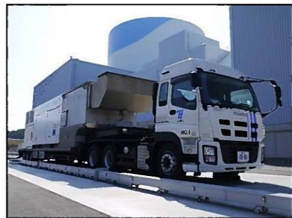
大容量空冷式発電機
