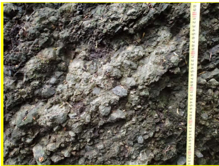
P5 防災科研調査において地滑り土塊南側端部とされる箇所付近の露岩状況 堅硬な岩盤（凝灰角礫岩）が認められる。
